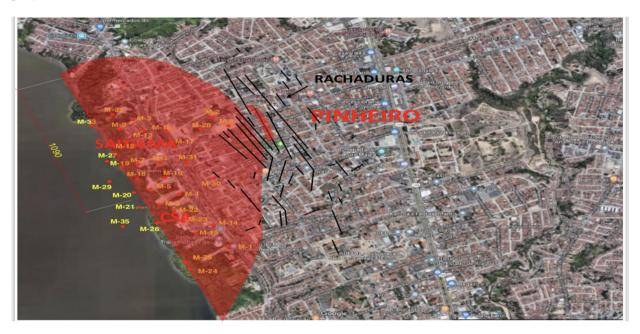
Todos os pontos no mapa representados por M-1 a M-35 correspondem aos poços que já foram ou estão sendo explorados pela mineradora Braskem. A área vermelha corresponde a parte dos bairros do Pinheiro, Mutange e Bebedouro que está em subsidência (afundamento). Os traços correspondem às rachaduras.
