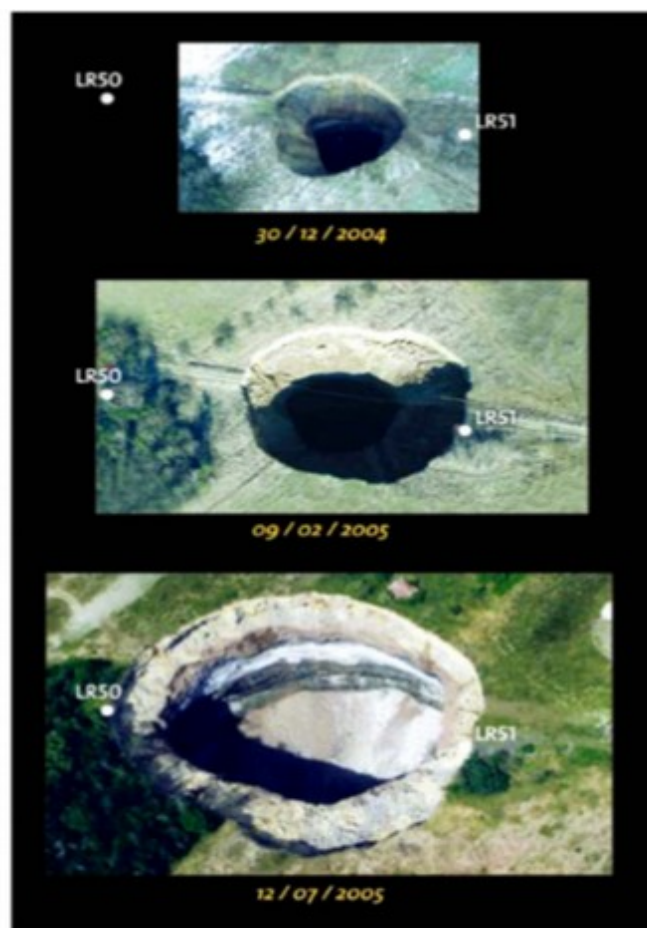
Figura 2.5 – Evolução de uma cratera provocada pela exploração de sal-gema, Nancy-França.
