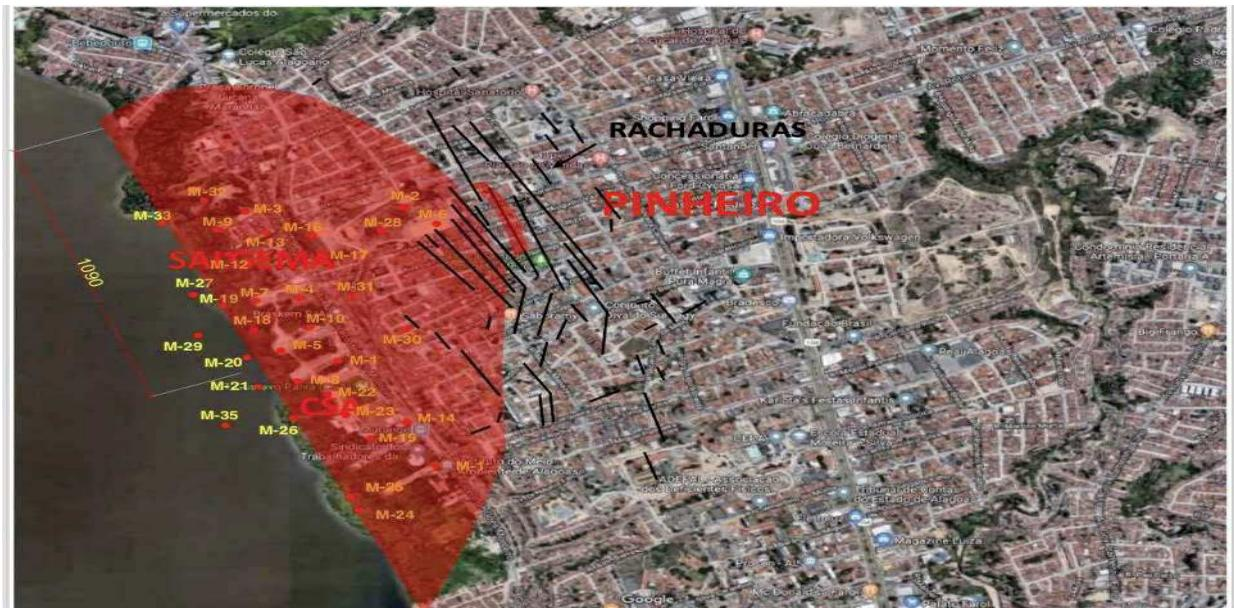
Todos os pontos no mapa representados por M-1 a M-35 correspondem aos poços que já foram ou estão sendo explorados pela mineradora Braskem. A área vermelha corresponde a parte dos bairros do Pinheiro, Mutange e Bebedouro que está em subsidênci a (afundamento). Os traços correspondem às rachaduras.
